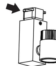
Para conectar a luminária ao trilho, utiliza o encaixe que fica na parte superior
