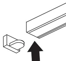
Coloque a ponteira de acabamento na ponta do trilho
